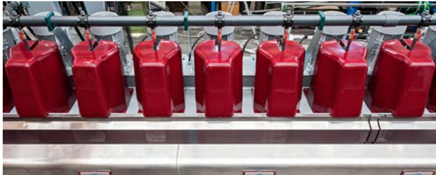
Kafaları taşıyan köprü detayı Detail of the spindle-holder beam
